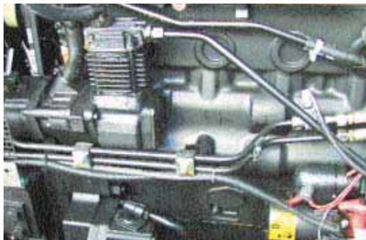
Čerpadlo servořízení a vzduchový kompresor (nahore) a hydrogenerátor (dole)
