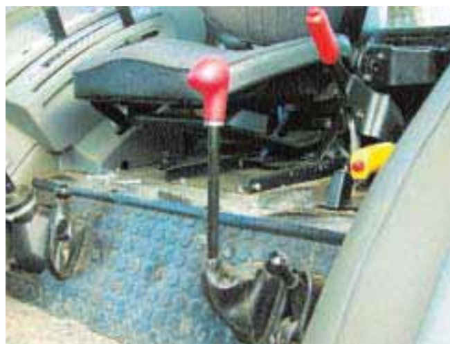
Vlevo ovládací páky traktorů s pětistupňovou převodovkou bez reverzace, vpravo ovládání šestistupňové reverzační převodovky. Místo páky pro změnu otáček vývodového hřídele je páka reverzace
