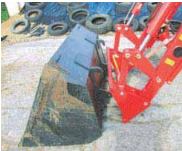
Použitá lžice s objemem 0,5 m 3 po odpojení od nakladače
