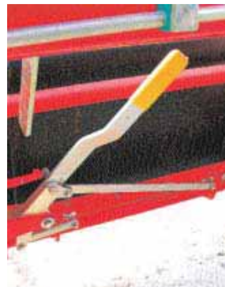
Páka pro vysunutí zajišťovacích čepů se po zapojení a zaklopení lžice sama zajistí
