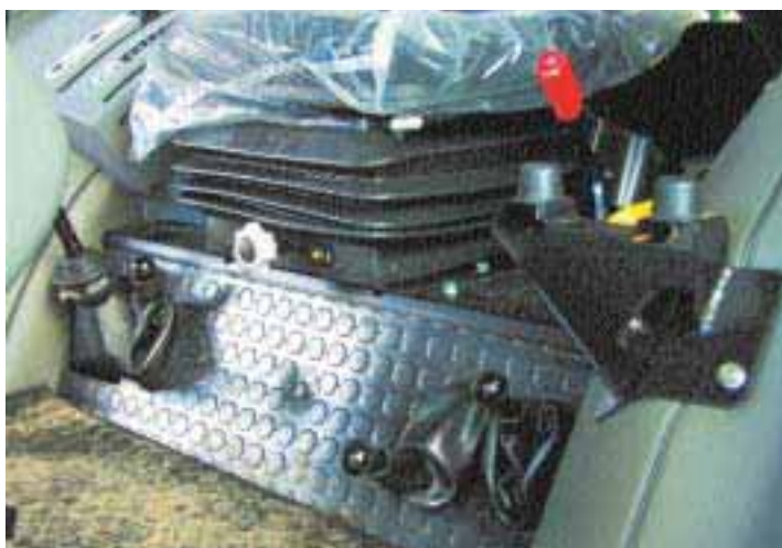
Vlevo ovládací páky traktorů s pětistupňovou převodovkou bez reverzace, vpravo ovládání šestistupňové reverzační převodovky. Místo páky pro změnu otáček vývodového hřídele je páka reverzace
