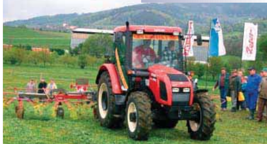
Proxima 6441 se šestirotorovým obrabečem píce OZ 671 z produkce Strojíren Rožmitál si vedla dobře a pokosená píce byla kvalitně rozhozena
