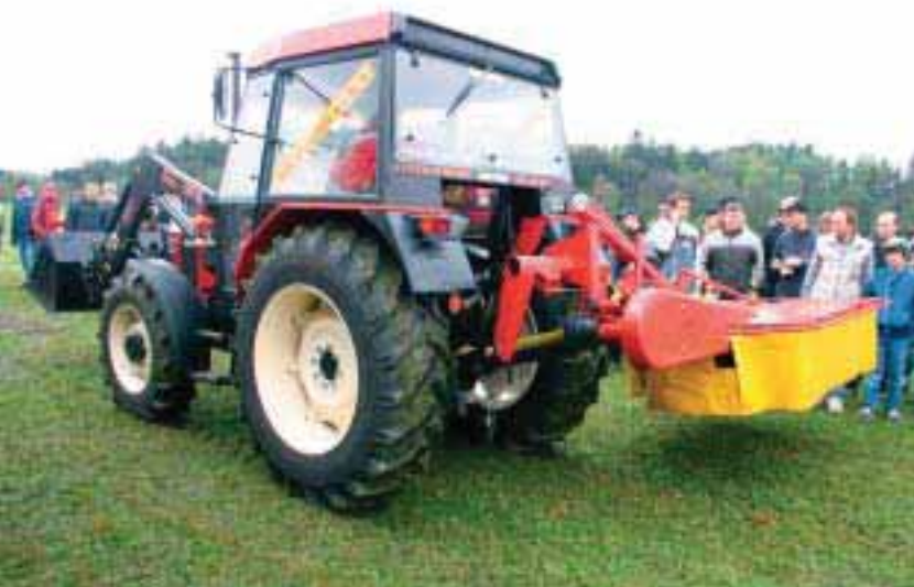
Tato kombinace Zetoru Major 7340 s bubnovým žacím strojem ZTR 165 z Agrostroje Pelhřimov a čelního nakladače Trac Lift 120 symbolizuje určení traktoru. Tedy manipulace, nebo lehčí polní práce zejména v písčinářské oblasti
