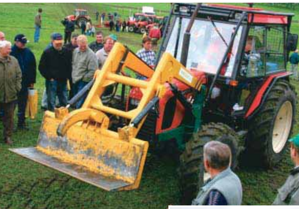
Major 6340 s čelním rampovačem Hercules 4 z PTR Třeboň a dvoububnovým navigátorem od téhož výrobce představuje obvyklou úpravu i model traktoru Zetor používaný v lesnictví. Přesně takovouto soupravu jsem si měl možnost prakticky vyzkoušet a i když se traktor zdá na lesní nástavbu výkonově slabý, svou práci si odvede a uživatel přitom oproti konkurenci ušetří značné finance při jeho koupi
