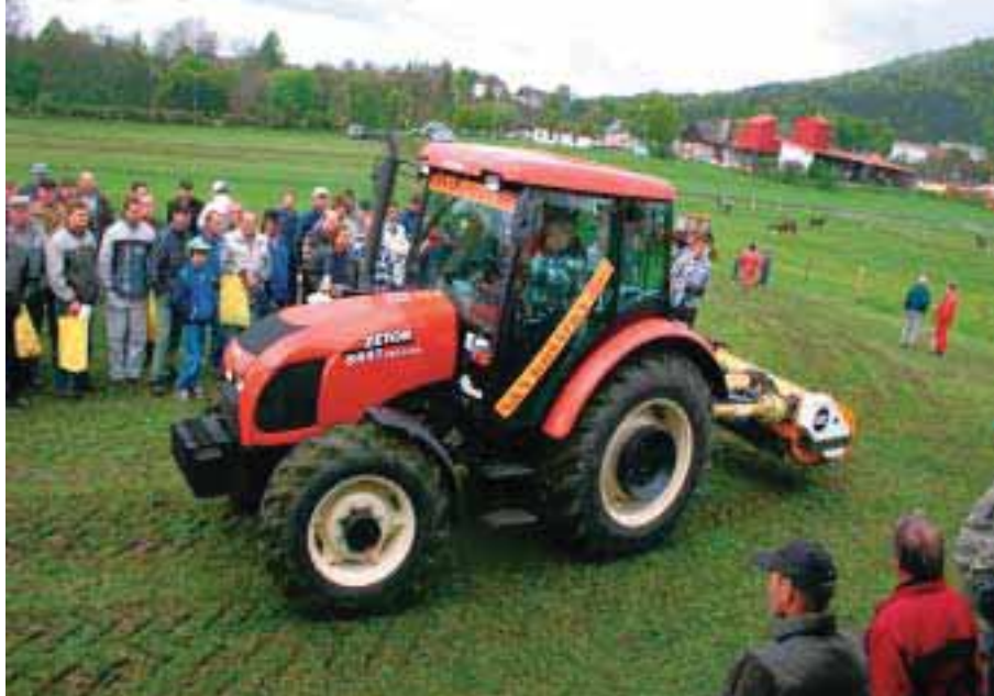
Zetor Proxima 8441 s mulčovačem La garde představuje soupravu vhodnou pro údržbu příkopů či okrajů pozemků nebo prostor v zemědělských areálech, na což 80 koní traktoru bohatě postačuje. Škoda jen, že je zatím v nedohlednu slibovaný model Proximy s výkonem 90 koní
