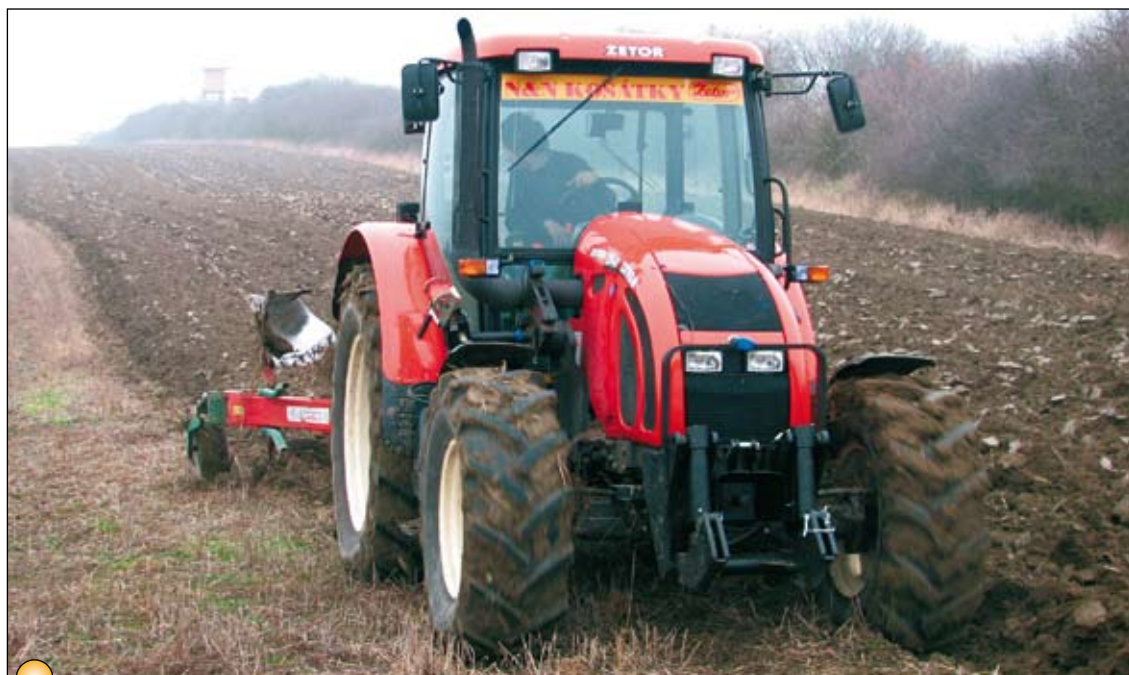
Souprava traktoru Zetor 124 41s pluhem Kverneland ES 85. V přední části traktoru je vidět snímač signálu GPS
