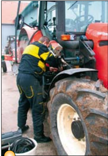
Montáž průtokoměru, který byl připevněn ke schůdkům do kabiny
