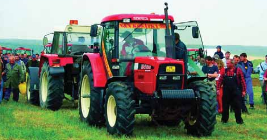
Měření pneumatik – první traktor má v této chvíli obuty nové diagonální pneumatiky a táhne vzadu připojený traktor, který má zařazen nižší převodový stupeň a tažný traktor tak brzdí. Měří se tažná síla, prokluz a spotřeba paliva
