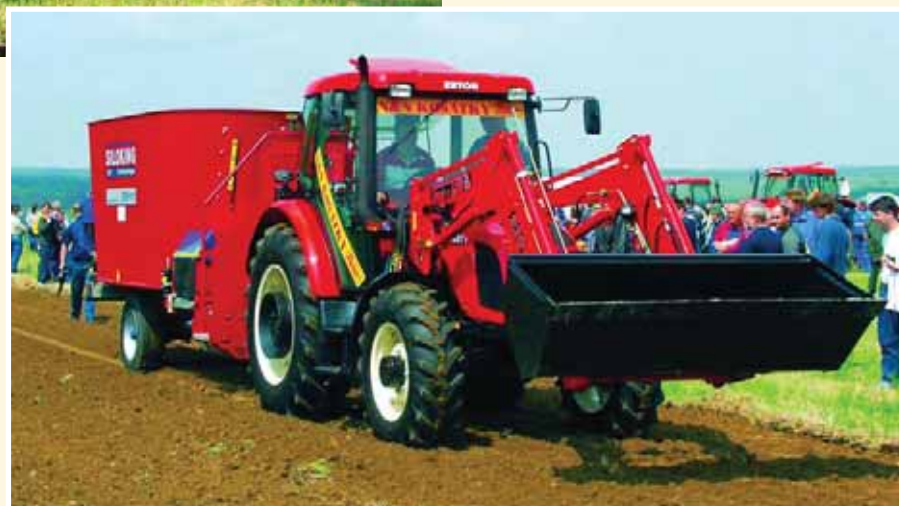
Další Proxima 8441, tentokrát s čelním nakladačem z Humpoleckých strojů a vertikálním KMV Mayer Siloking
